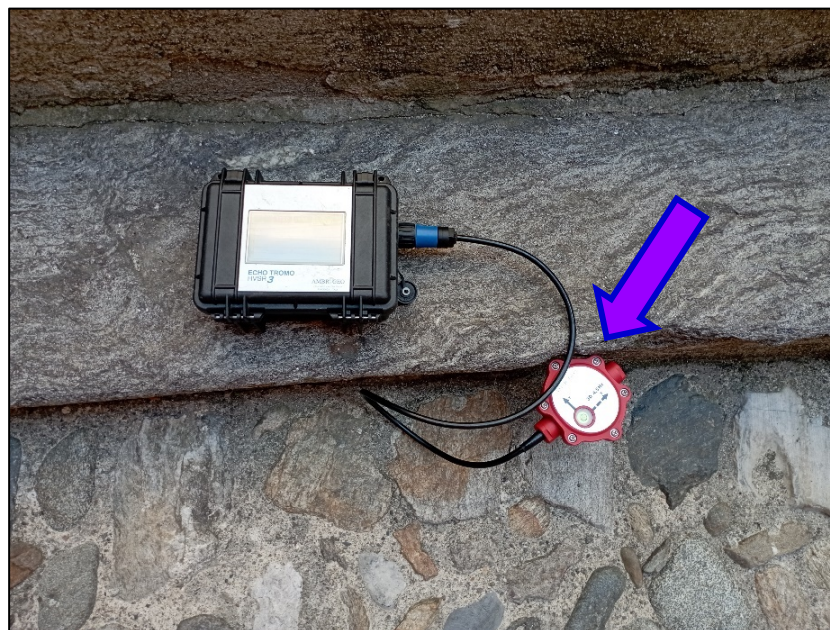
Fig. 11 – Punto di esecuzione indagine di sismica passiva HVSR1 con strumentazione ECHO TROMO HVSR 3
