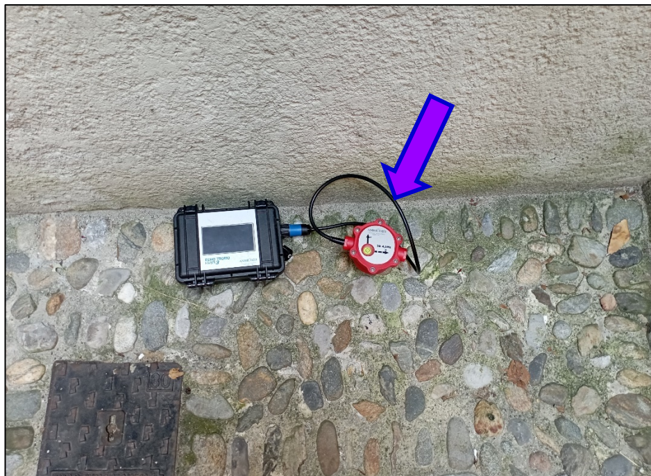
Fig. 24 – Punto di esecuzione indagine di sismica passiva HVSR2 con strumentazione ECHO TROMO HVSR 3
